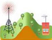
Рельеф местности (сложные условия приема возникают в низинах, в районах с сильно пересеченным рельефом местности, непосредственно за лесными массивами и железнодорожными насыпями)
