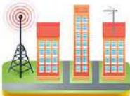
Плотность застройки местности (между передающей антенной телекомпании и местом установки приемной антенны возникают экраны для радиоволн – высокие здания)
